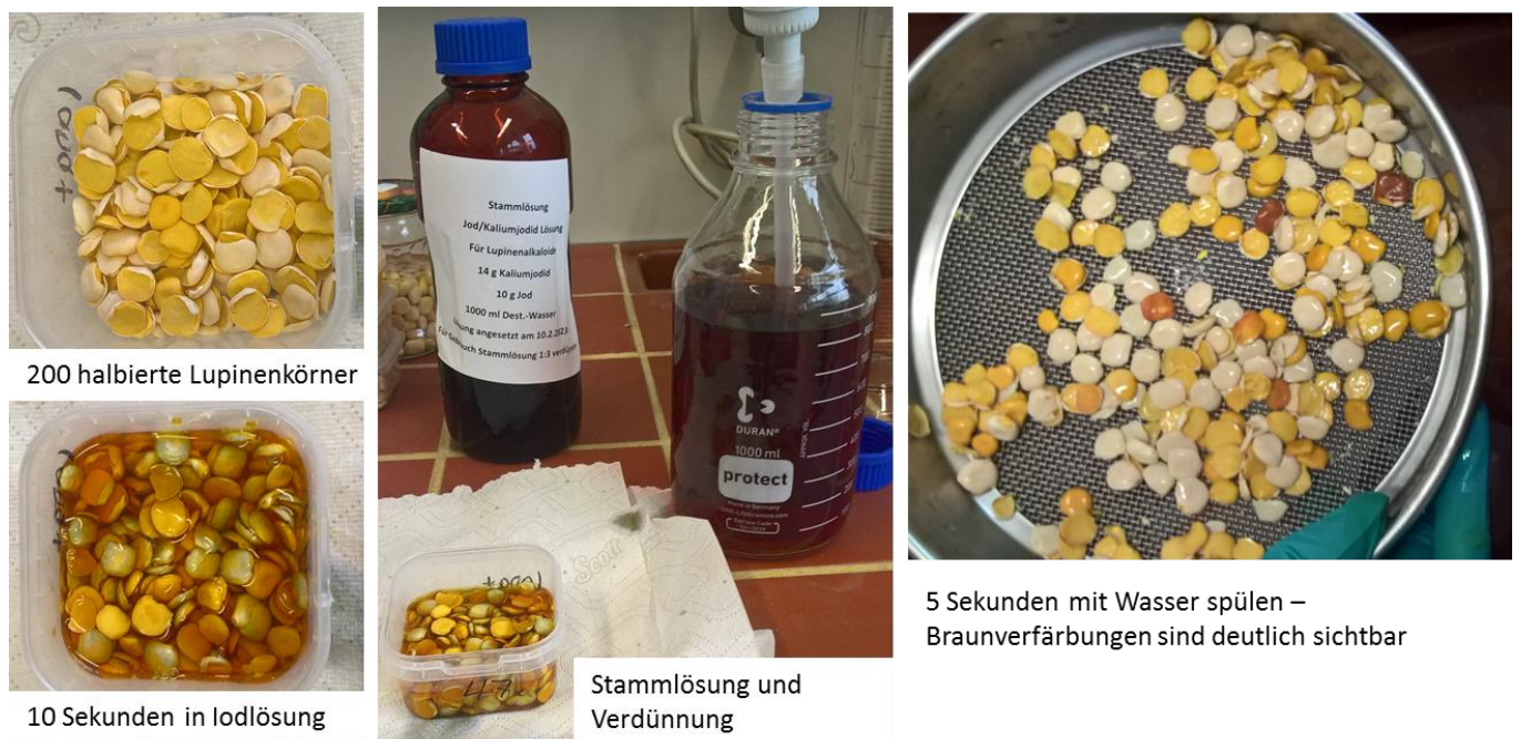
Abb. 12: Ablauf der qualitativen Bestimmung des Bitterkornanteils in Weißer Lupine nach EG-VO Nr. 73/2009
